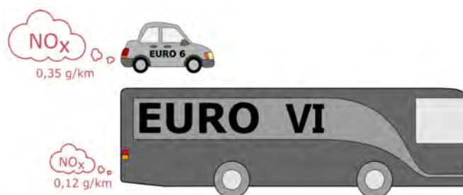
Figura 2.2 Emissioni su strada di NO x di un'automobile diesel Euro 6 e di un bus diesel Euro VI a confronto
